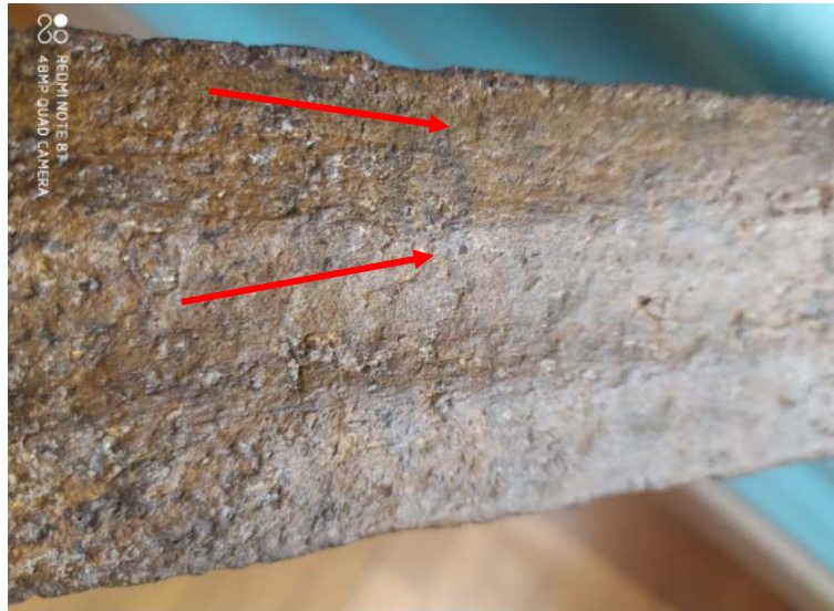
Figura 13. Vista parcial. (Fuente: el autor) Se observan a simple vista las líneas de forja
