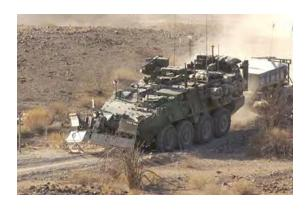
STRYKER LAV III ESV (Engineer Squad Vehicle) con AMS de PEARSON y remolcando una manguera dragaminas pesada (MICLIC).
