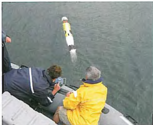
Los pequeños vehículos submarinos no tripulados (UUV) se pueden convertir en la herramienta adecuada para la detección, localización e identificación de amenazas en el perímetro marítimo, ya sea como elemento de reacción o realizando patrullas programadas.
