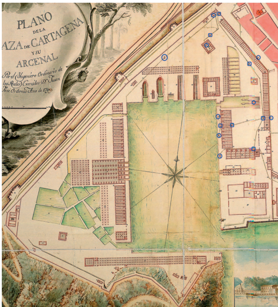
Plano (parcial) en el que figura la red completa de abastecimiento de agua potable en el arsenal, 1799. (Instituto de Historia y Cultura Militar, Cartoteca, ORDOVÁS, AT-161-27)
