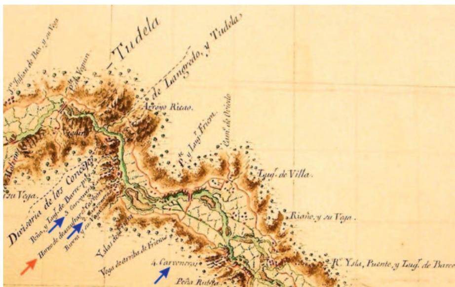
Fig. 10. Fragmento del Plano topográfico del río Nalón, elaborado por la Comisión de Planos, en el que se ha resaltado el emplazamiento del horno de La Riera (flecha roja) y las minas de carbón más próximas (flechas azules). [FUENTE: Instituto Geológico y Minero de España]
