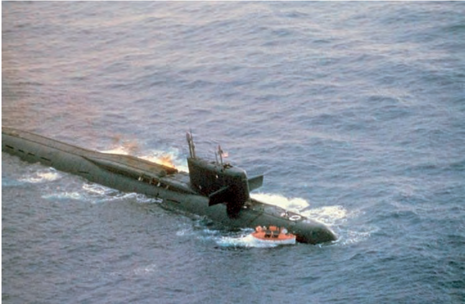
El K 219 fotografiado desde un avión de patrulla marítima norteamericano, probablemente el día 4 de octubre. El bote salvavidas es de uno de los mercantes soviéticos, y se aprecian el destrozo en cubierta y la humareda de oxidante. (Foto: U. S. Navy).
