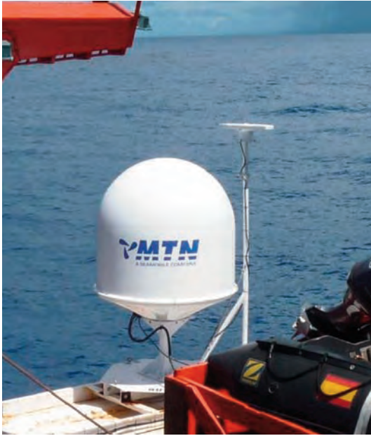
Antena VSAT marino.
