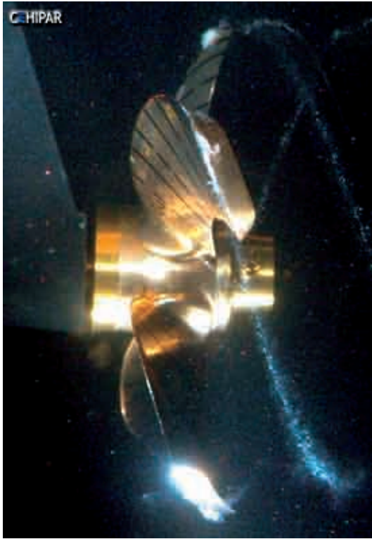
Figura 7. Ensayo de cavitación.
