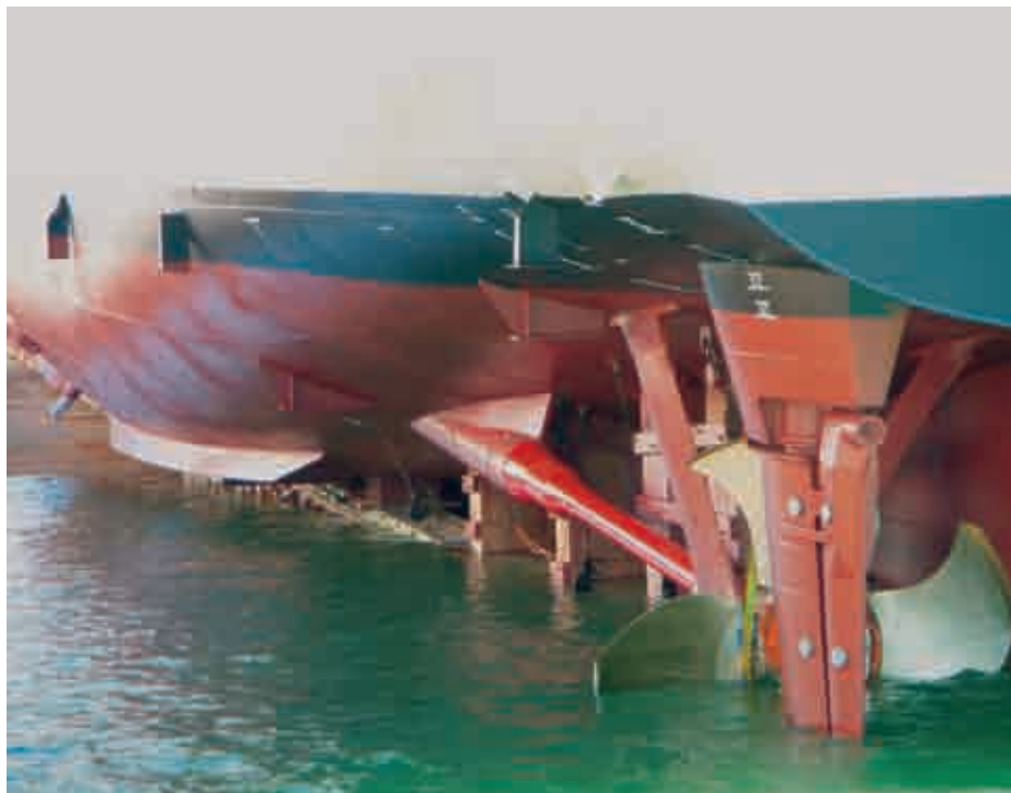
Figura 8. CLT Instalada en el BAM.
