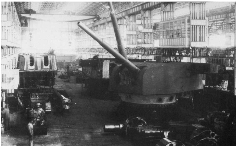
Las torres dobles núm. 2, 3 y 4 del crucero Canarias . Fábrica de San Carlos. (Foto: Libro La Construcción Naval Militar española ).
