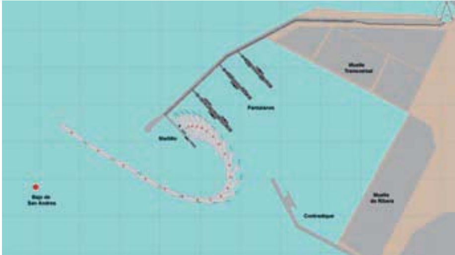
Figura 3. Maniobra de salida del buque VLCC en lastre desde la punta del Martillo (Langosteira) con viento del SW 25 nudos y olas de 4,5 metros.
