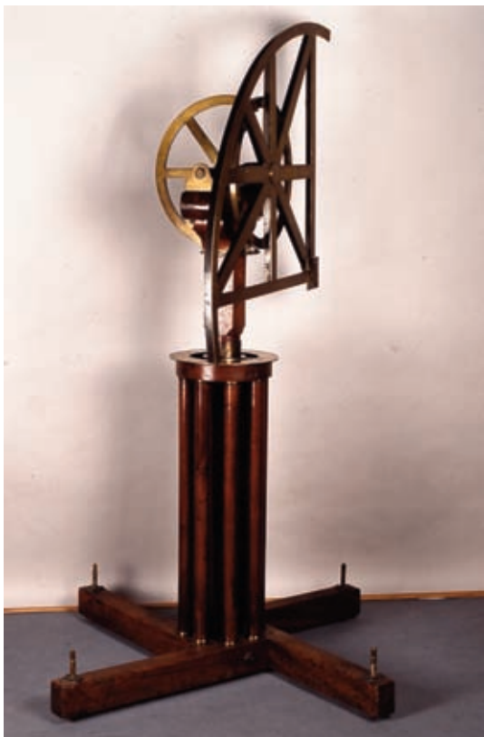
Cuadrante acimutal y de altura fabricado por John Bird en Londres, y utilizado por Jorge Juan y Ulloa.
