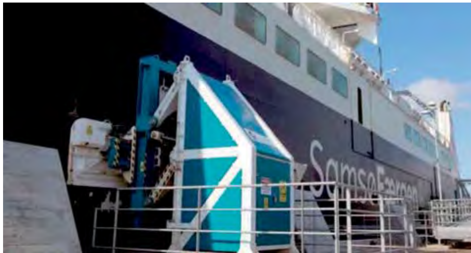
Unidades de amarre automatizadas en el puerto de Saelvig, Dinamarca.
