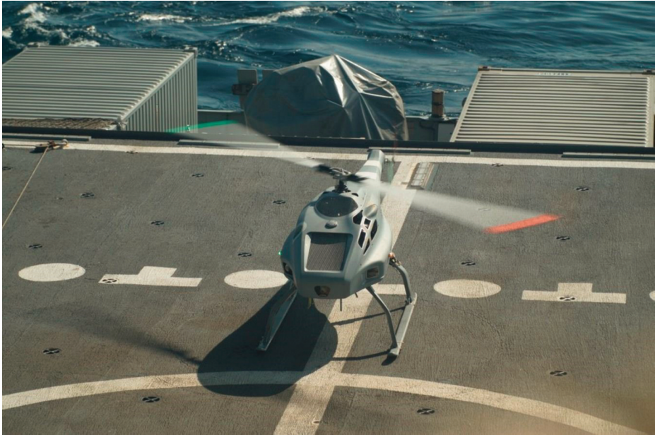
Vehículo aéreo no tripulado (UAV) Skeldar despegando de la cubierta del BAM Meteoro (Operación ATALANTA, septiembre-noviembre 2013). En esta ocasión, la demanda operativa forzó a realizar la integración del «ingenio» con el buque en zona de operaciones.
