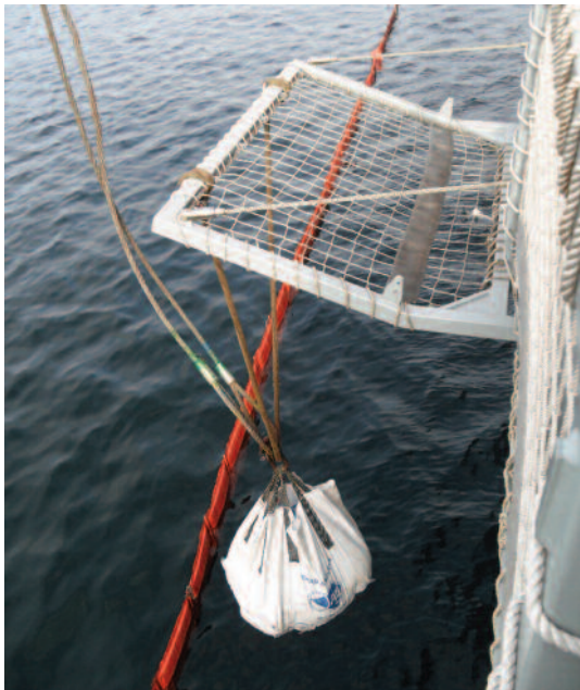
Prueba de resistencia de red de cubierta de vuelo en la fragata Cristóbal Colón en 2012.
