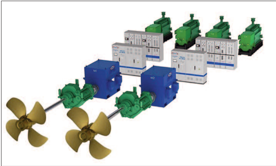
Disposición típica de propulsión diésel-eléctrica.
