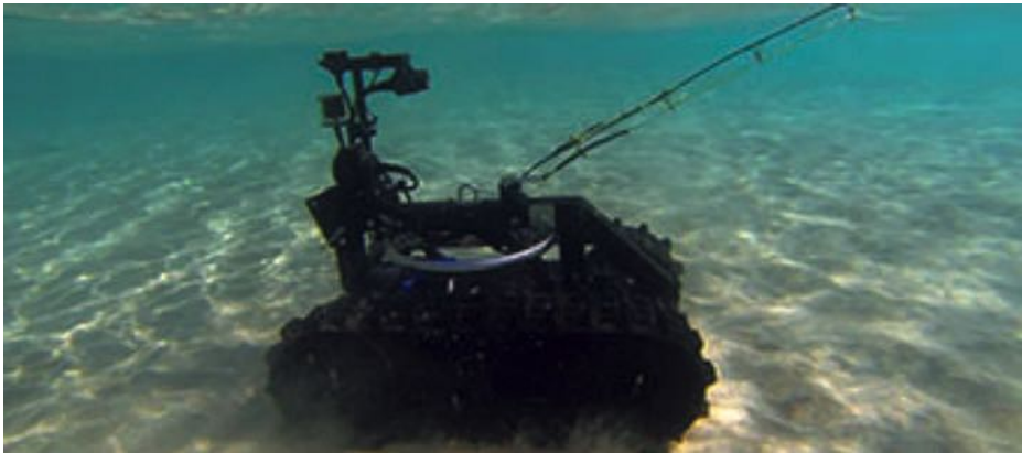
ROV submarino TALON-C de Qinetiq para operaciones anfibas. (Fuente: https://www.qinetiq.com/ ).
