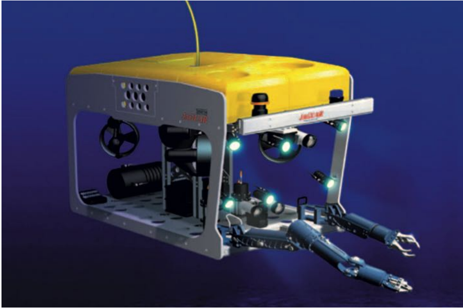
ROV Seaeye Jaguar de Saab operado de forma remota. (Fuente: https://www.saabseaeye.com ).
