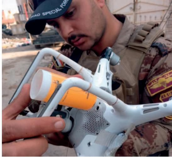
DJI Phantom con dispositivo para lanzamiento de granadas de 40 mm usado por el Daesh.
