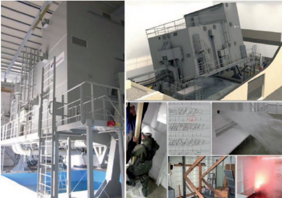
Adiestrador de control de averías fabricado en Alemania. (Fotografía facilitada por el autor)
