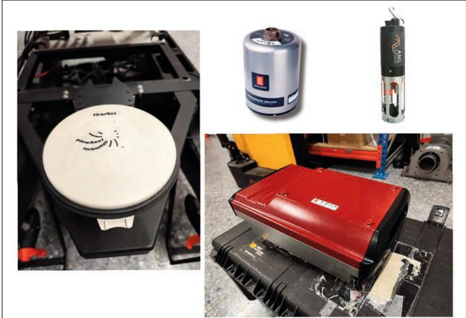
Equipos hidrográficos del USV serie *Veril*. Arriba, sondador, IMU y perfilador de velocidad de sonido. Abajo, Seapath 130 con sus antenas y unidad de proceso. (Fuente: archivo del IHM)
