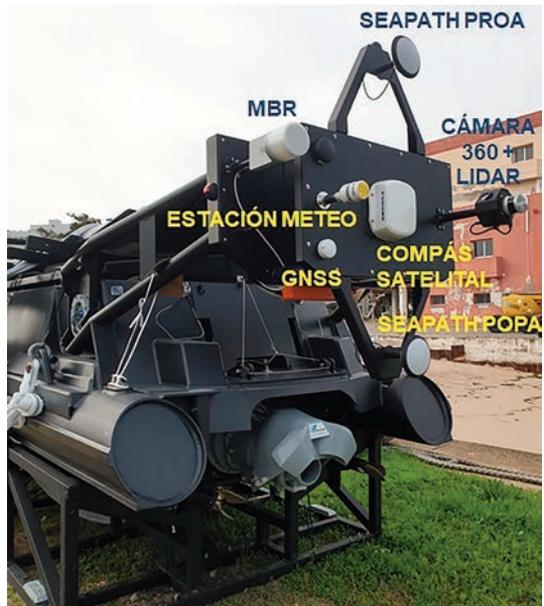
Sensores del USV *Sonda-01*.
