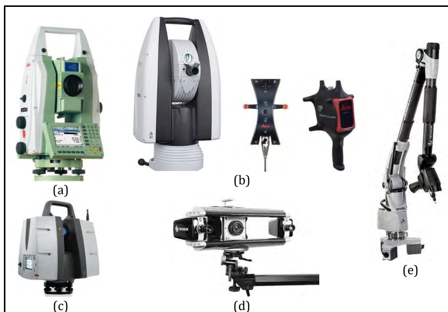
Figura 2. Instrumentos de medición: (a) Estación Total; (b) Láser tracker con palpador y escáner láser; (c) Láser escáner; (d) Escáner de luz blanca y (e) Brazo articulado con palpador y escáner láser. (Fuente: < www.hexagonmi.com y www.leica-geosystems.com >)
