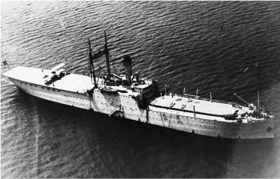
Vista aérea del Dédalo (fondeado) en la que se aprecian, de proa a popa, el mástil de atraque de dirigibles, los dos cañones de 105 mm, el hangar de transporte de un dirigible, los palos con grúas para el izado y arriado de hidroaviones, y la cubierta de transporte de hidroaviones y vuelo
