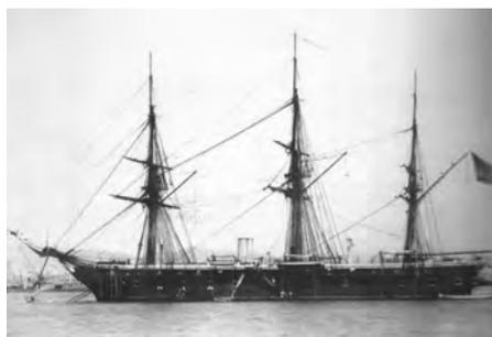
Izqda., la fragata blindada *Zaragoza*, con 5.620 toneladas de desplazamiento y artillada con 30 cañones de 6 a 8 cm; dcha., la fragata de hélice y casco de madera *Carmen*, con un desplazamiento de 3.116 t y artillada con 50 cañones, lisos y rayados, de diferentes calibres (22, 20, 16, 15, 12 y 8 cm), emplazados en las baterías principales y en colisa de proa, así como para el artillado de lanchas y botes
