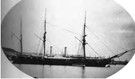
Arriba, fotografía del vapor de guerra de 1.<sup>a</sup> clase *Fernando el Católico*, rebautizado por los cantonales como «*Despertador del Cantón*». Desplazaba 316 t y en 1873 estaba artillado con 2 cañones de 32 libras (lisos de 120 mm)
