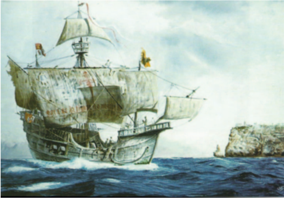
La nao Victoria de la expedición de Magallanes, con la que Elcano regresó a España en septiembre de 1522, después de haber dado toda la vuelta al mundo. Se pueden ver el aparejo, los cintones, las bulárcamas y el ancla de estribor en su estiba. Acuarela de González Aledo. (Museo Naval de Madrid)
