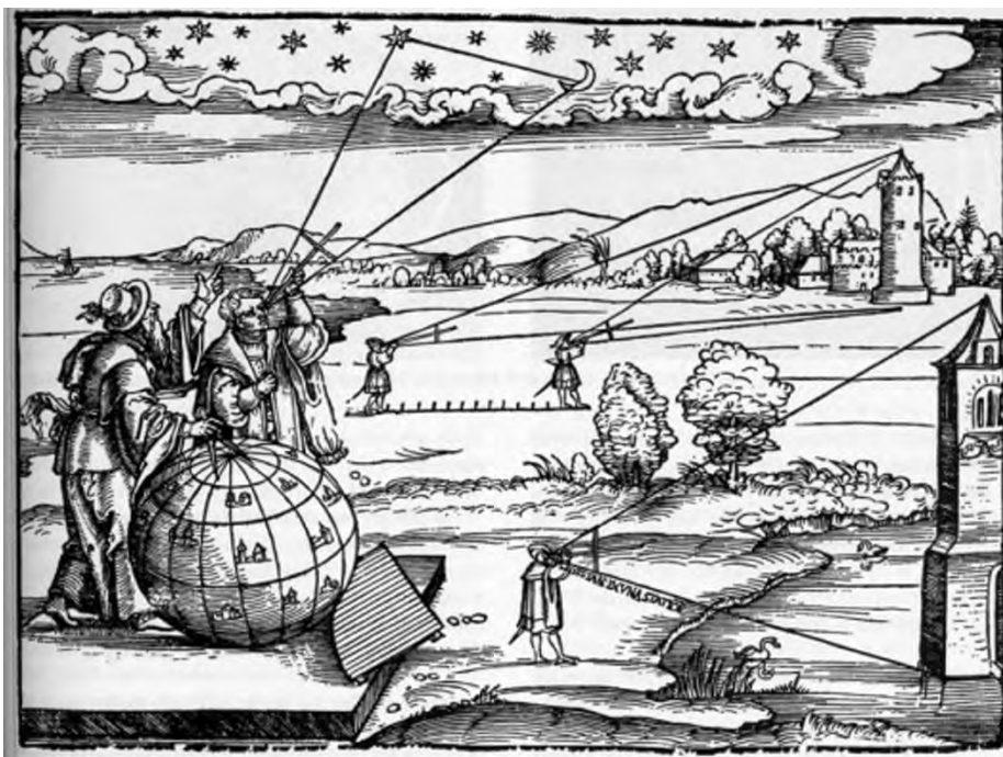
Uso de la ballestilla para medir la distancia lunar. Grabado de la obra de Apiano Introducción geográfica .
