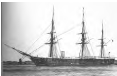
Fragatas de hélice Almansa y Lealtad , artilladas con medio centenar de cañones de 20 a 8 cm, emplazados en baterías laterales.
