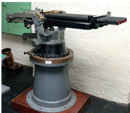
Ametralladora Nordenfelt de 25,4 mm, de cuatro cañones, en montaje naval. No tiene instalado el cargador en la parte superior del montaje y le faltan los volantes de accionamiento. (Foto: Archivo MdR Almirante de Castilla)
