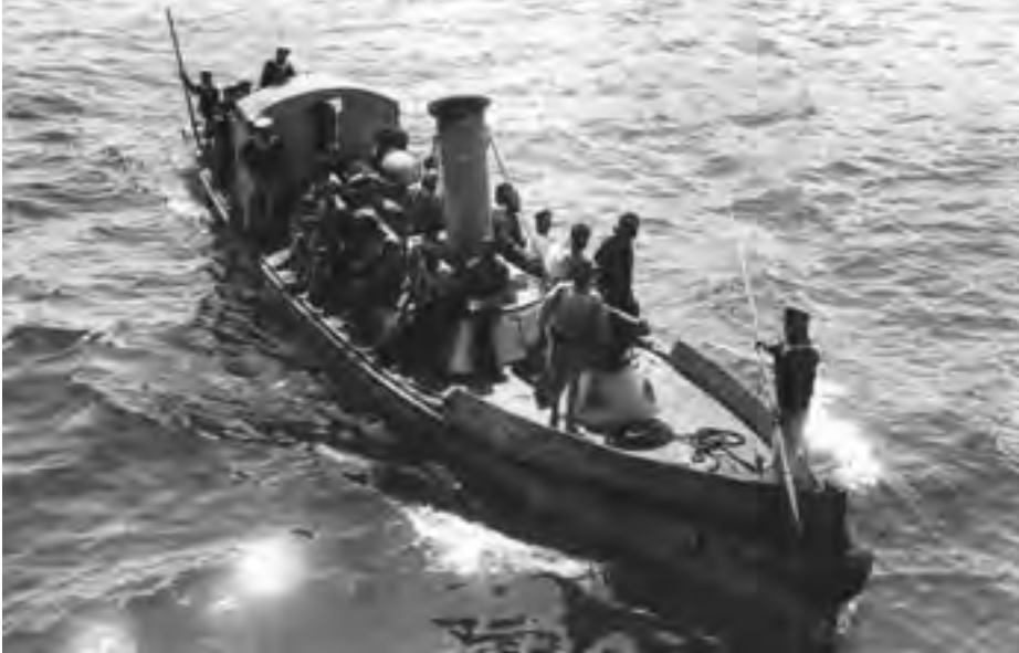
Un picket boat o pinnace , en este caso perteneciente al acorazado HMS Triumph , de la clase Swiftsure, botado en 1903 y hundido por un submarino en 1915. Tenía unos diecisiete metros de eslora. (Foto Archivo MdR Almirante de Castilla)
