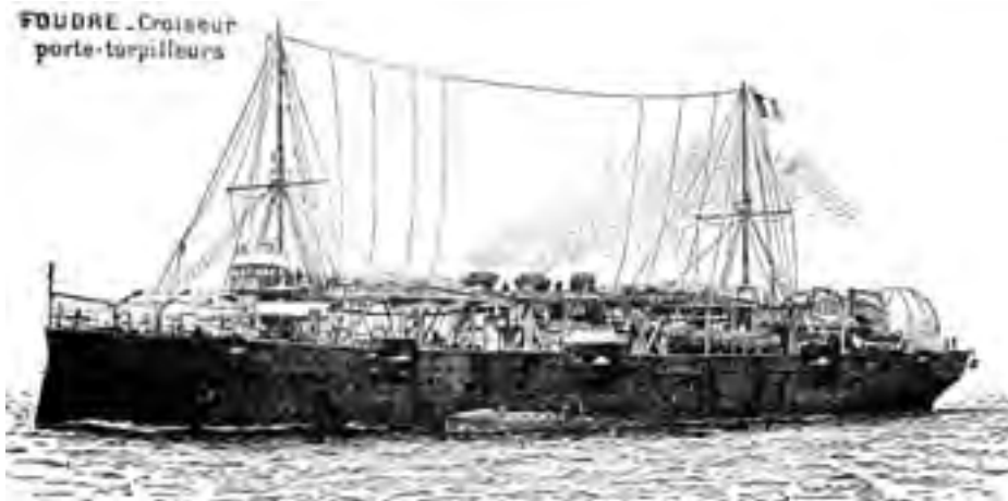
Dibujo del crucero portatorpederos Foudre , de la Marina francesa. Se puede apreciar el sistema de estiba, arriado y elevación de los torpederos. (Foto Archivo MdR Almirante de Castilla)
