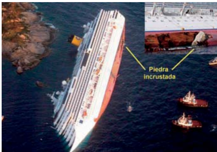
Posición final del Costa Concordia y avería en su costado: la foto principal está tomada la mañana siguiente de la tragedia, y la ampliación de la esquina superior derecha unas semanas más tarde. (Montaje propio sobre una foto de autor desconocido y otra de Giampiero Sposito).
