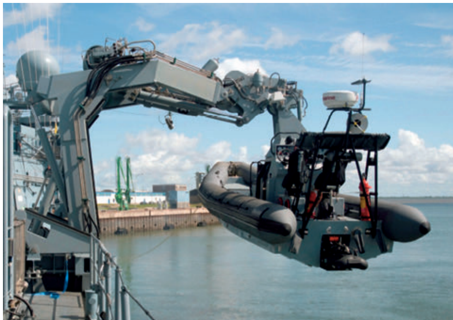
Grúa de costado.
