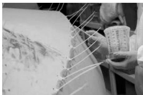
*Cosido y estratificado (stich and glue).*—El argumento básico para la construcción «punto y pega» es que son necesarios menos pasos en la elaboración del forro. La construcción inicial es más rápida y más fácil, utiliza menos piezas y no requiere moldes de construcción. A largo plazo, el barco es mucho más
