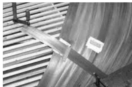
*Strip-planking en proceso compuesto.*—El *strip planking* es una forma de construcción de embarcaciones en madera que se puede considerar como una variación de la construcción a tope tradicional, pero en la que los banzos son mucho más estrechos y tienen sección cuadrada o prácticamente cuadrada.
