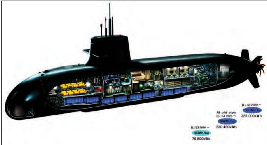
Fig. 5. Vista de un submarino clase *Soryu* equipado con baterías de litio.
