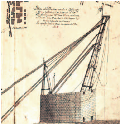
Detalle del plano del puerto de La Habana y su Arsenal en 1789, que muestra cómo fue finalmente construida la machina. Véase la leyenda.
