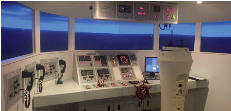
Consola de gobierno de los puentes 1 y 2 del SIMNAV de la ENM. (Foto del autor)
