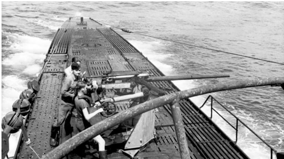
Tripulantes de un submarino Tipo IXB manejando el cañón SK C/30U de 37 mm, un arma efectiva con la que podían defenderse de los atacantes aéreos. (Fuente: Bundesarchiv)
