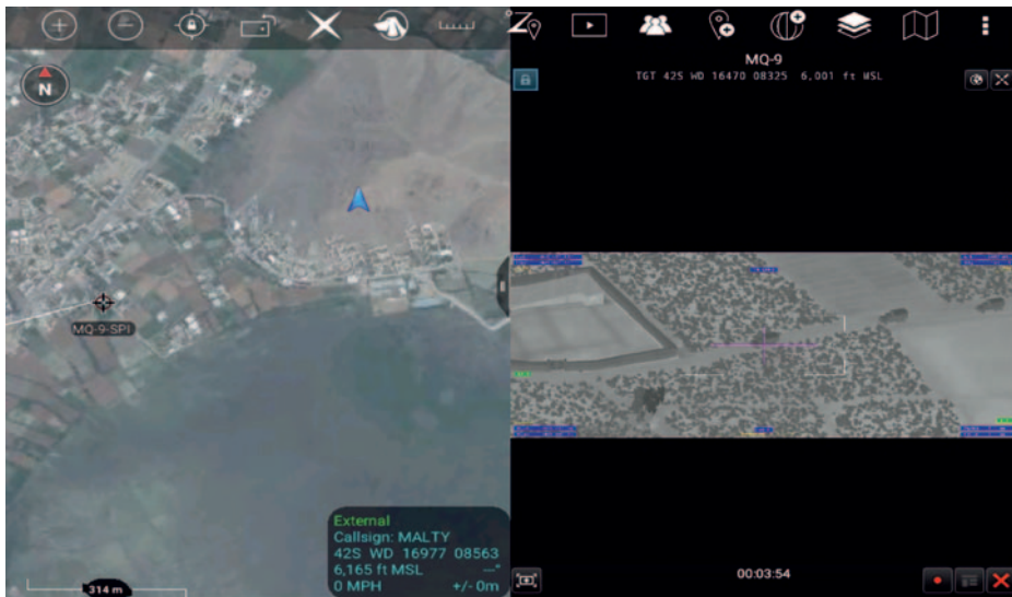
Aplicación TAK conectada a un sistema ROVER. La aplicación reproduce el video recibido del sensor de la aeronave. (Imagen simulada con fines didácticos)
