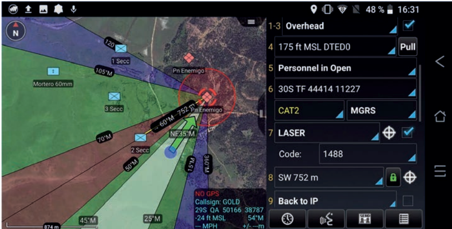
Imagen de la versión ATAK usada para generar el formato 9-líneas para una misión CAS. La aplicación representa de manera visual el rumbo de ataque de la aeronave con una flecha verde. También se aprecian los ángulos de seguridad para el empleo de un designador láser. (Imagen simulada con fines didácticos)
