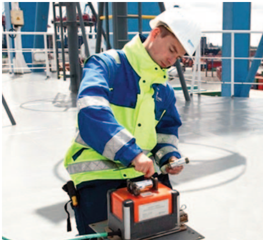
Técnico de mantenimiento actuando sobre la caja fija de un VDR. (Fuente: MacGregor)
