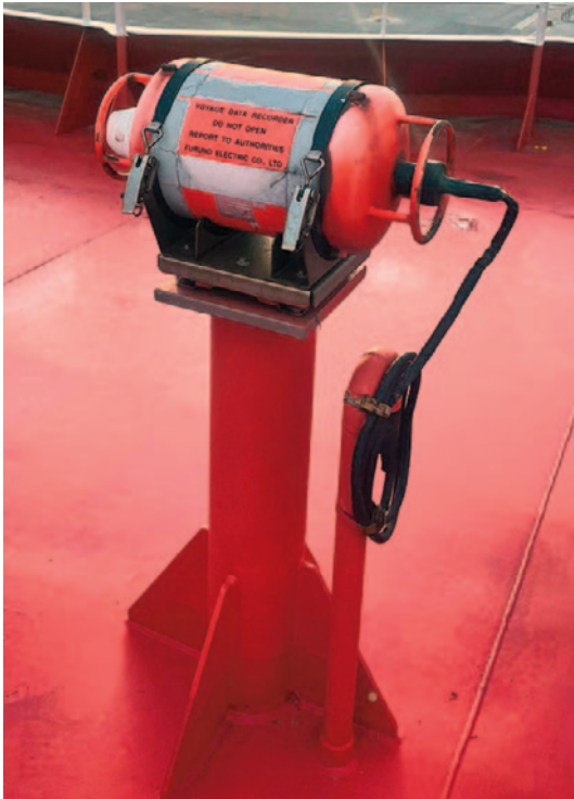
Detalle de un VDR fijo en el petrolero Haci Fatma Ana . (Fuente: Pelayo Infante)
