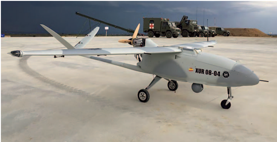
El RPAS Atlantic perteneciente al GAIL II/63 del Ejército de Tierra es utilizado principalmente para la adquisición y corrección de fuegos artilleros. (Fotografía facilitada por el autor)
