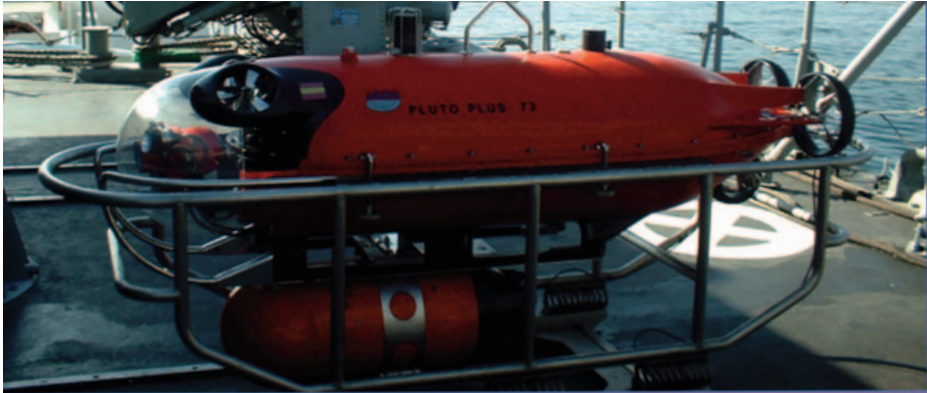
ROV Pluto Plus portando una carga de contraminado con 80 kg de alto explosivo (60 por 100 RDX y 40 por 100 TNT). (Foto: Armada)
