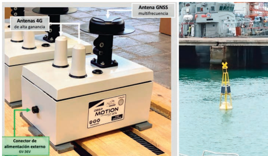
Figura 13. Instalación del equipo DeepMotion en boyas de propiedad del IHM durante las pruebas de validación de los equipos. (Fuente: Deep Insight-IHM, 2022)
