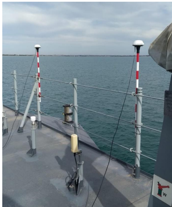
Instalación de las antenas GPS en el puente alto del “Audaz”
